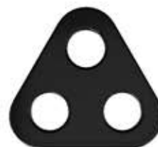
Ref.: APT 3F 8mm Medida interna: 8mm Materiais: POM, PC e HS Embalagem: 200 unidades
